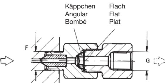
**Supports de disques de rupture SITEC**
